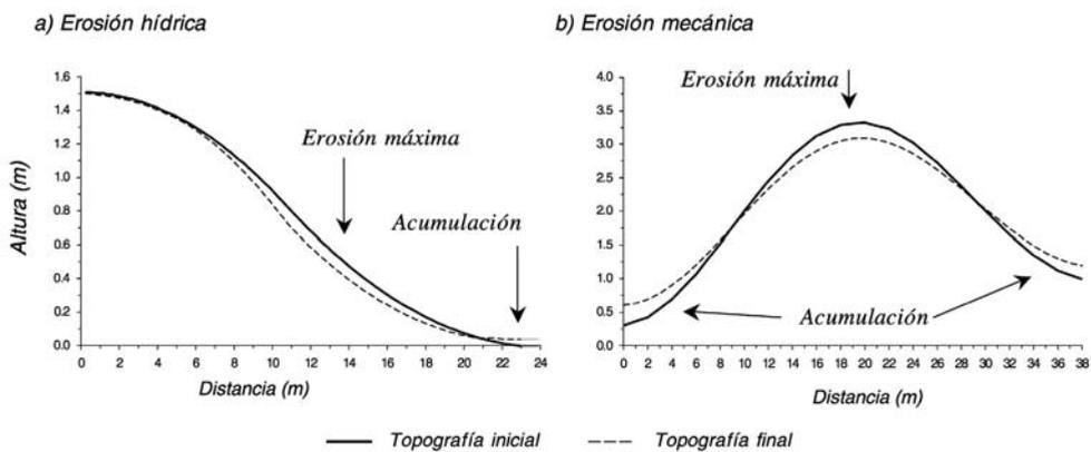
**FIGURA 7:** Variabilidad espacial de las zonas de erosión y acumulación de suelo como resultado de los procesos de a) erosión hídrica según el modelo WEPP – Water Erosion Prediction Project (Flanagan y Nearing., 1995), y, b) erosión mecánica según el modelo SORET – Soil Redistribution by Tillage (De Alba, 2003).
