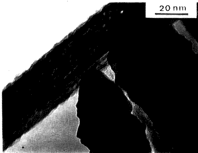
Fig. 8. Cristal de hematites de forma acicular en (001) visto al microscopio electrónico de transmisión en alta resolución. Las microcaras laterales son probablemente {012}.
